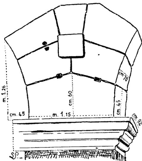
Fig. 95. - Costruzione e dimensioni dei piedritti del Navale.
